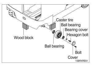
(3) Rod wheel bolt. • Fastening torque : 4.5~5.5 kgf·m
